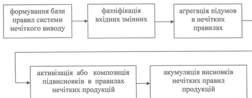
Рис. 1. Структурна схема роботи інформаційної системи безпечної експлуатації технічного стану будівель
